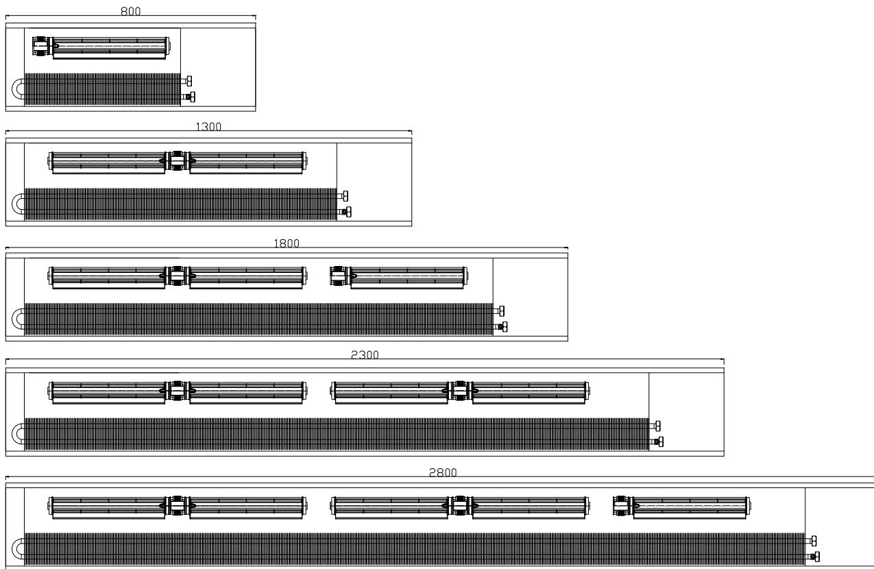
Рис. Длина встраиваемых конвекторов с вентилятором тип TURBO VKN.
